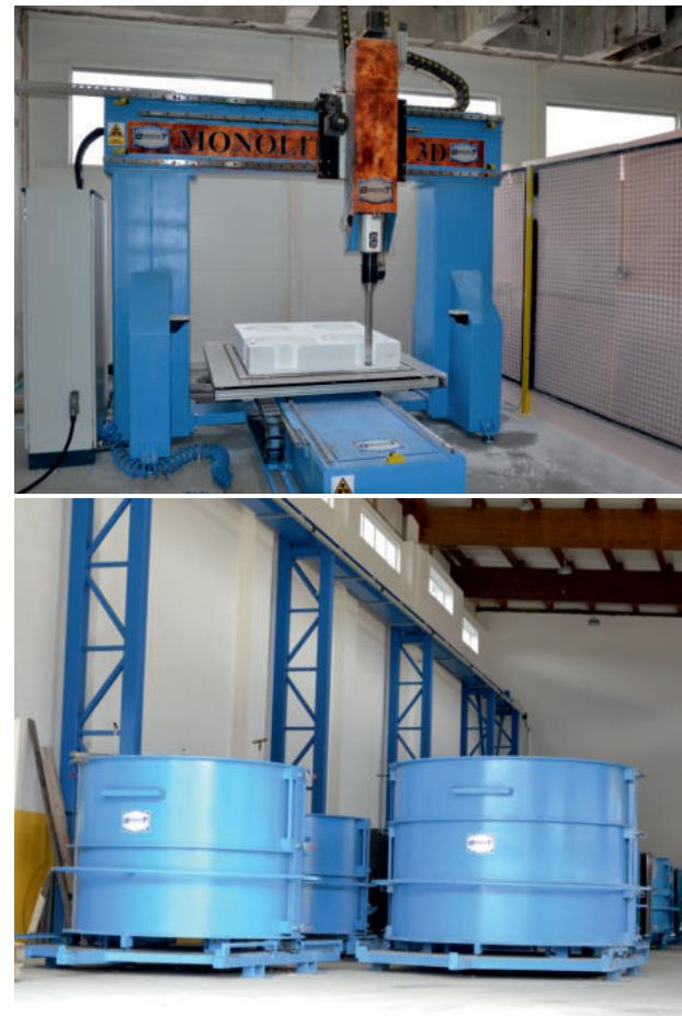
Technologický celok zahŕňa zariadenie: výrobu betónu ,výrobu betónových produktov, prepravy a manipulácie s výrobkami, odformovanie výrobkov, čistenie a ošetrovanie výrobkov. Tieto zariadenia sa ovládajú alternatívnymi spôsobmi – manuálne, alebo naprogramovaným/poloautomatickým i plnoautomatickým priebehom, ktoré sú zamerané na presnosť a kvalitu konečného výrobku.
